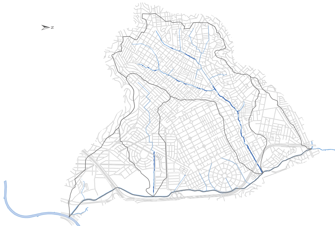
FIGURA 7.4 Áreas sujeitas a inundações para chuvas de Tr 200 anos: cenário com as obras da 4ª etapa das Alternativas 1 e 2
