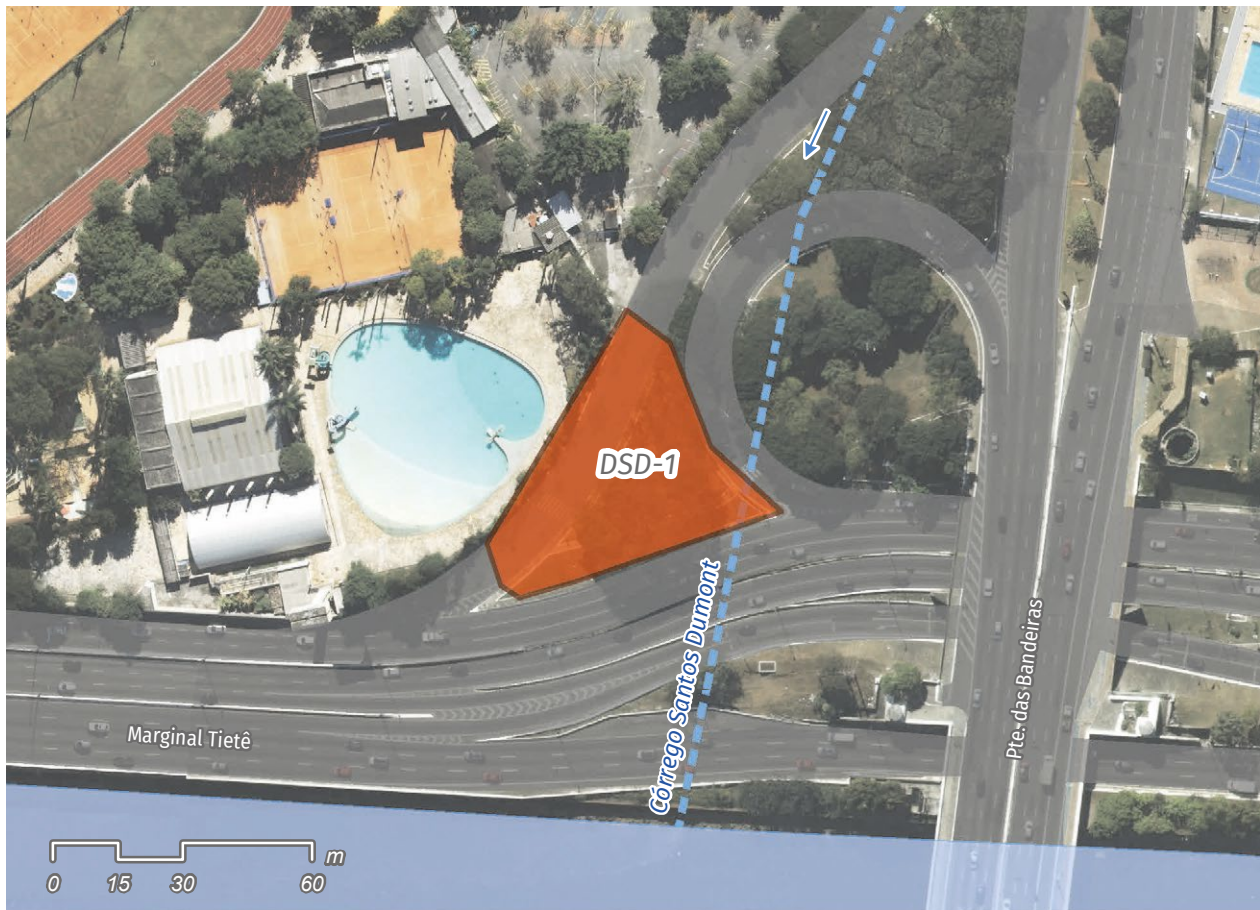
FIGURA 6.21 Localização do reservatório do pôlder Santos Dumont 1, na Área de Contribuição Direta entre as bacias dos córregos Carandiru e Ten. Rocha, alternativas 1 e 2
