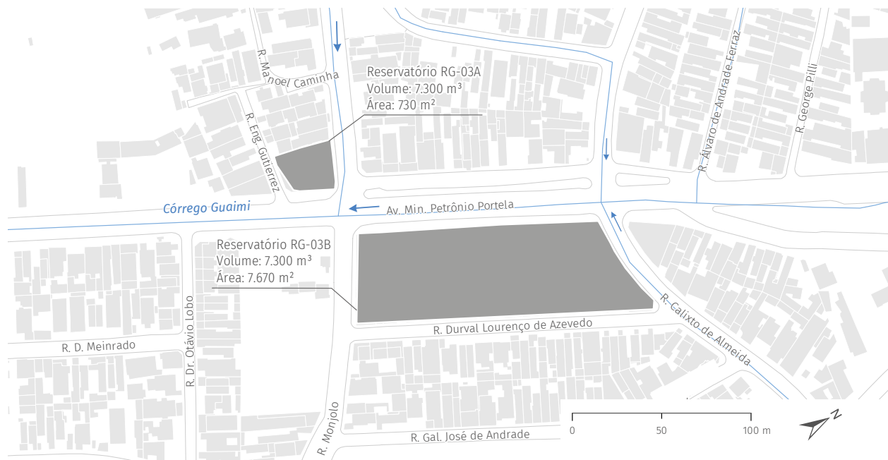
FIGURA 5.8 Áreas sugeridas para a implantação do reservatório RG-03 (MHS Engenharia Consultoria Ltda., 2010)
