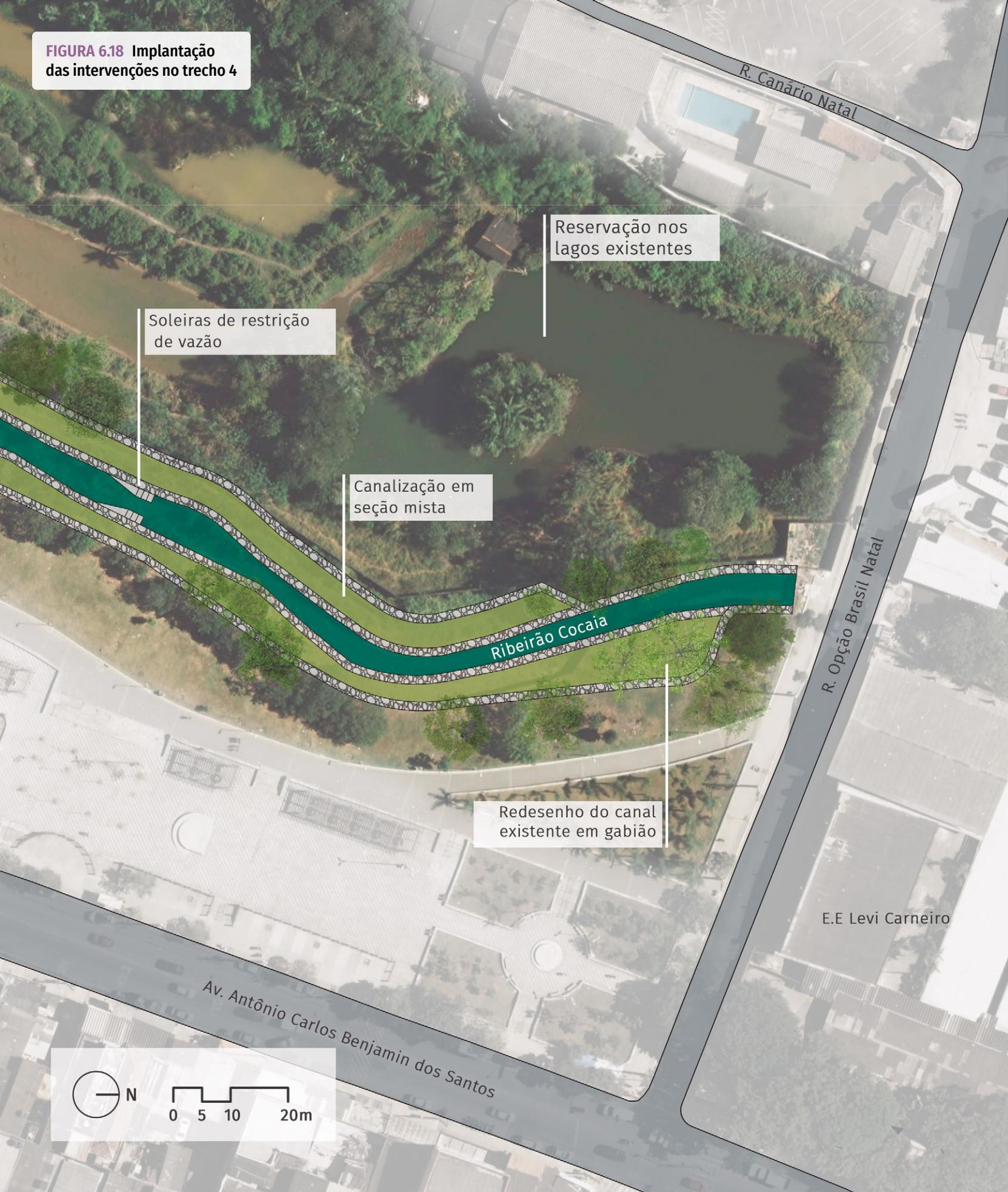
**FIGURA 6.19** Representação da situação existente e da situação proposta no trecho 4
