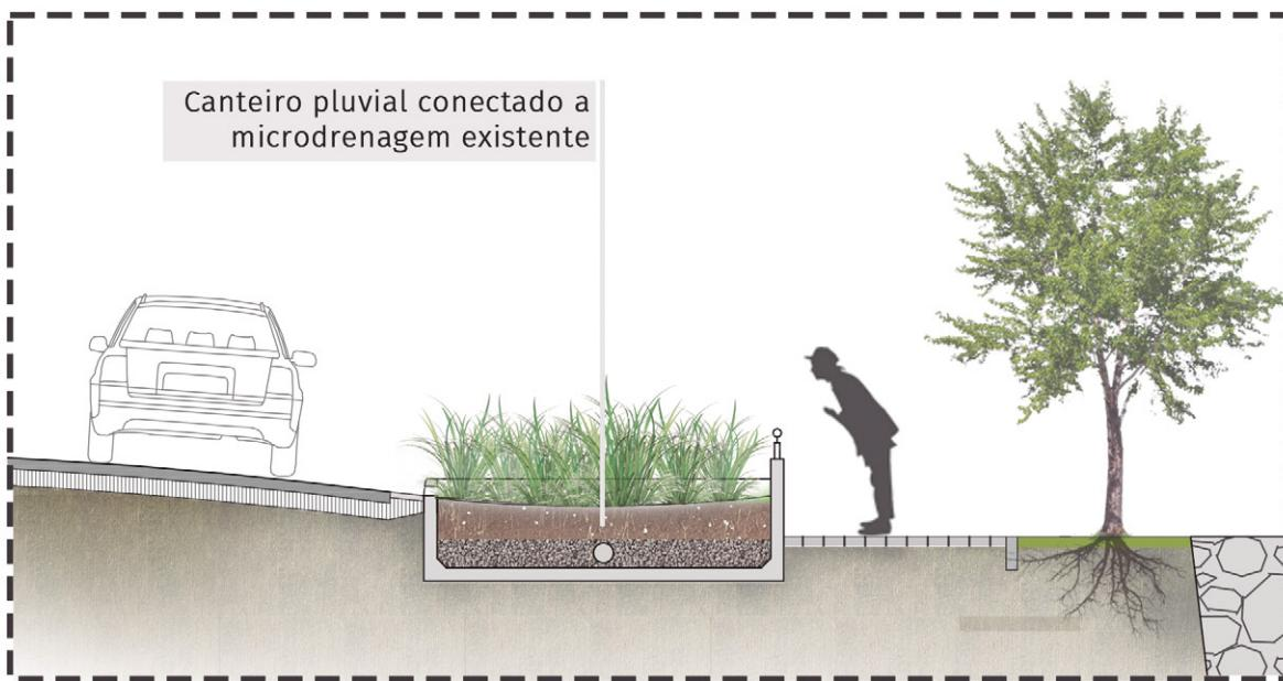
Detalhe 01 - Canteiro pluvial
